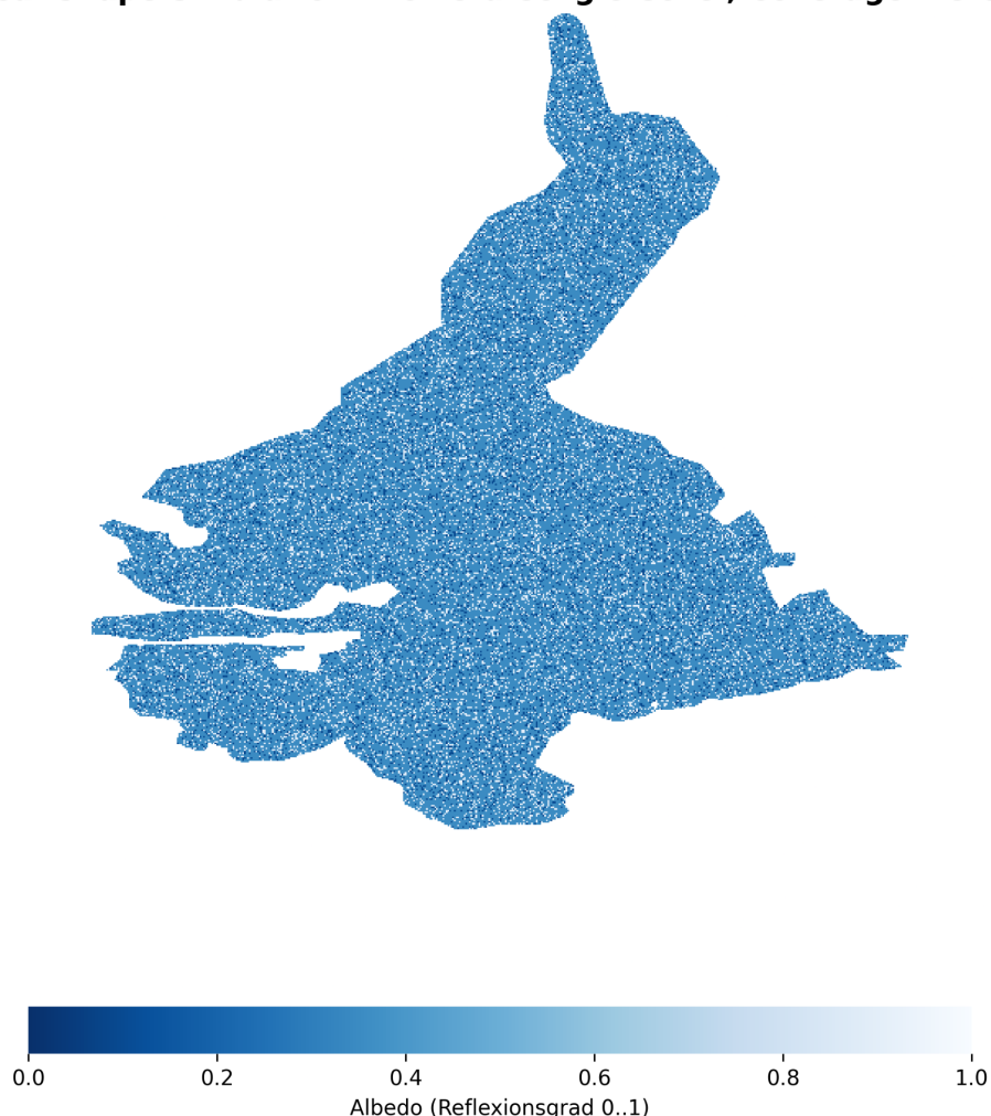
Abb 1: Simulations-Output für den Morteratschgletscher. Gezeigt ist die algorithmische Verteilung der Schutzschicht (Weiss) auf den 15% dunkelsten Zonen (Coverage 0.15).
